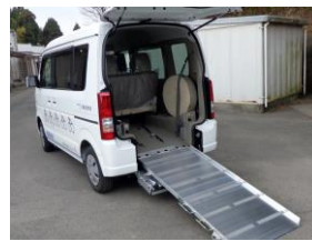
車いす対応スロープ使用時
